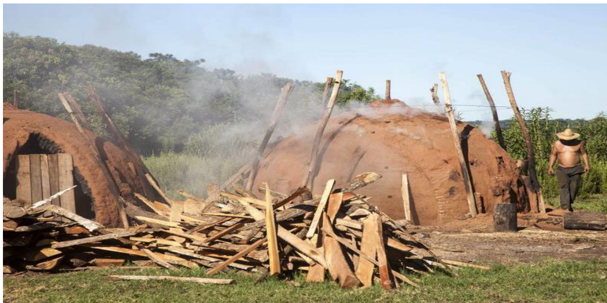
Foto 01 – Elaboración de Carbón Vegetal a partir de Desechos de Aserraderos
